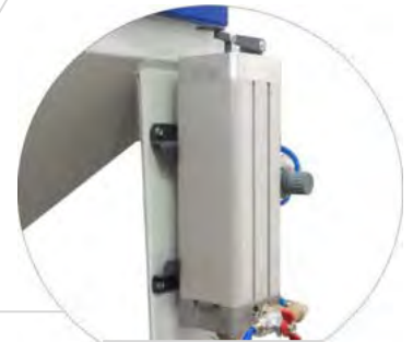
Mikrotryskač pro intenzivní bodové tryskání
