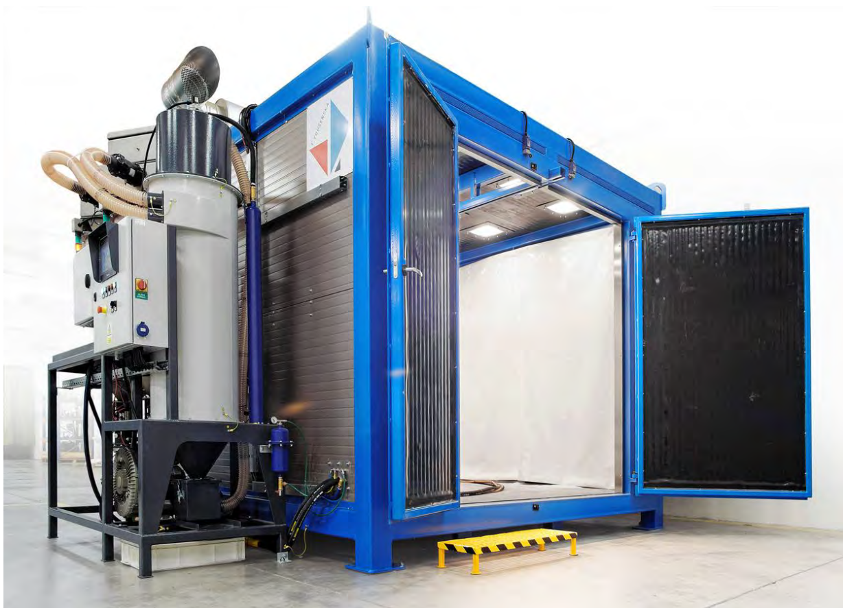
Komora 3 x 3 m s podlahovým odsáváním a zdvojenou jednotkou vnějšího oběhu. Umožňuje rychlé střídání abraziva pákovým přepínačem (např. mezi korundem a skleněnou balotinou). Každý tryskací materiál má vlastní čistič a zásobník.
