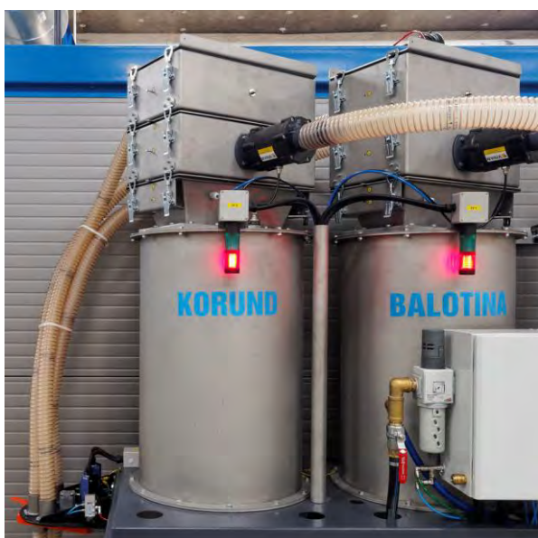
Pneumatická jednotka pro dopravu abraziva umožňující střídat tryskací materiály v jedné komoře. Po odsátí jednoho typu abraziva do příslušného zásobníku se zařízení přepne pro podávání jiného tryskacího prostředku (v tomto případě korund a balotina).
