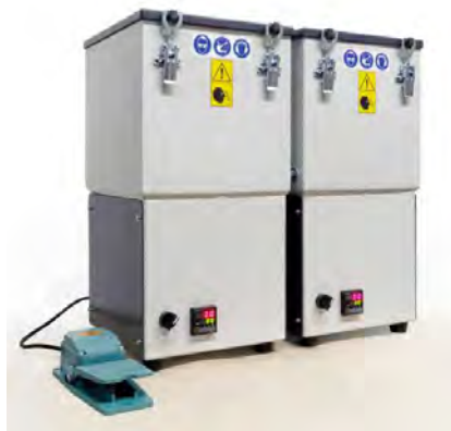
Uvedená varianta je ovládána nožním pedálem. Je možné také ovládání ručním spínačem
