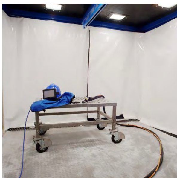
Interiér komory s pneumatickým odsáváním.
